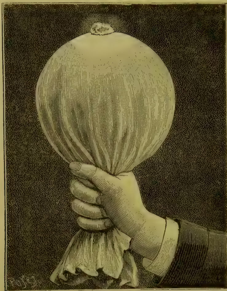
Fig. 96. Carbone incandescente collocato sopra un fazzoletto di tela batista che avvolge una sfera di rame. Il fazzoletto non brucia.
